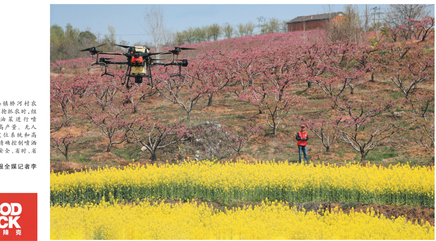
随州洪山镇桥河村农业专业合作社抢抓农时,组织无人机为油菜进行喷药防病,以提高产量。无人机通过GPS定位系统和高精度传感器,精确控制喷洒剂量和范围,安全、省时、省力、高效。
